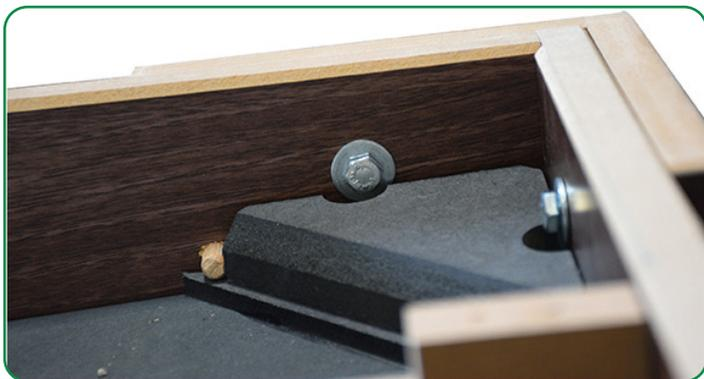
Remplacez le cache boulon dans l'angle du coffre.
