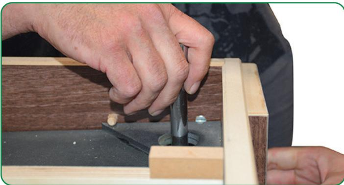
Présentez le pied sous le coffre en face de son trou de fixation et **prévissez** le boulon de fixation et sa rondelles par l'intérieur du coffre, avec une clé à douille, sans forcer.
